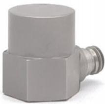
RA572P系列产品采用金属焊接密封，专为在高温恶劣环境下做振动测量和测试而设计的一款轻型加速度传感器，此产品也是工业振动、冲击测试用标准加速度传感器。RA572P的产品自带10-32的螺纹安装孔，同时此加速度传感器可在无外部供电的情况下自己产生信号。RA572P产品特殊的晶体结构设计使其具有低基座应变灵敏度、高谐振频率，和输出长期稳定的特性。信号地与外壳相连，10-32的侧出连接器搭配低噪声的同轴线缆可以保证信号无失真，与之相配的低噪声线缆型号为11P-L可选。
