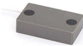
RA519A是一款可同步测量冲击和振动的IEPE加速度传感器，其特点是采用环形剪切模式的压电陶瓷晶体为敏感元件，具有长期保持输出稳定的特性。此加速度传感器的内部电路是在IEPE的两线制系统上同时提供恒流源激励和传输低阻抗电压输出信号。信号地与外壳相连，可选配绝缘安装座。信号放大电路设计考虑了冲击保护。外壳采用激光焊接工艺以保证产品的密封性；整线输出保证了产品不同环境下使用时的测量可靠性和长期稳定性。RA519A系列加速度传感器支持粘合剂安装，也支持 $\varnothing 3.05 \times 2$ 的通孔牢固安装。RA519A系列加速度传感器具有频带响应宽和抗冲击的特性，所以对于轻质量结构分析和瞬态冲击测量的应用来说，RA519A绝对是一款理想的加速度传感器。
