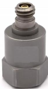
RA517P产品是专为高幅值冲击测量设计的一款轻量化的压电加速度电荷输出加速度传感器，产品密封性好，非常适合在恶劣环境下使用，且该产品是碰撞/冲击测试用标准传感器。针对高幅值冲击测试，RA517P产品提供螺柱安装方式，此产品具有自发电功能，工作时无需外部供电。RA517P产品采用压电陶瓷晶体为敏感元件，工作模式为环形剪切模式，产品具有低基座应变灵敏度、高谐振频率、输出长期稳定等特性；信号地与外壳相连。RA517P产品采用顶出10-32的连接器，可搭配低噪声同轴线缆可获得高品质信号，融安科技可提供10-32接头转BNC接头的低噪声同轴线缆，型号11P-3供客户选用。
