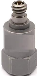
RA517A系列产品是一款可同时测量振动和冲击的IEPE单轴加速度传感器，其特点是采用环形剪切模式的陶瓷晶体为敏感元件，具有长时间保持输出稳定的特性。此加速度传感器的内部电路是在IEPE系统的两线制上同时提供恒流源激励和传输低阻抗电压输出信号，信号地与外壳相连，绝缘安装螺丝及安装座可选；同时信号放大电路设计考虑了极性反向保护。外壳采用激光焊接工艺以保证产品的密封性；输出连接头采用微型10-32的玻璃绝缘连接器以满足不同环境下使用时输出的稳定性。RA517A系列加速度传感器提供M5的螺柱以便牢固安装；RA517A系列加速度传感器具有宽频带响应特性，广泛应用于轻量结构产品做冲击测试；同时也应用于包装行业的跌落测试设备。另外，神州融安还提供与传感器接头配套的10-32转BNC接头线缆，型号11-L可选，具体参见配件表格。
