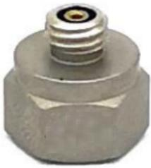
RA513A系列产品是一款可同时测量振动和冲击的IEPE单轴加速度传感器，其特点是采用环形剪切模式的陶瓷晶体为敏感元件，具有长时间保持输出稳定的特性。此加速度传感器的内部电路（可选TEDS功能）是在IEPE系统的两线制上同时提供恒流源激励和传输低阻抗电压输出信号，信号地与外壳相连，绝缘安装螺丝及安装座可选；同时信号放大电路设计考虑了极性反向保护。外壳采用激光焊接工艺以保证产品的密封性；输出连接头采用微型10-32的玻璃绝缘连接器以满足不同环境下使用时输出的稳定性。RA513A系列加速度传感器通过粘合剂安装，同时标配绝缘垫片；RA513A系列加速度传感器具有宽频带响应特性，广泛应用于轻量结构产品做振动、冲击测试；同时也应用于包装行业的跌落测试设备。另外，融安科技还提供与传感器接头配套的10-32转BNC接头配套线缆，型号11-3可选，具体参见配件表格。
