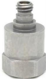
RA511A系列是一款可同时测量振动和冲击的IEPE单轴加速度传感器，其特点是采用环形剪切模式的陶瓷晶体为敏感元件，具有长时间保持输出稳定的特性。此加速度传感器的内部电路（可选TEDS功能）是在IEPE系统的两线制上同时提供恒流源激励和传输低阻抗电压输出信号，信号地与外壳相连，绝缘安装螺丝及安装座可选；同时信号放大电路设计考虑了极性反向保护。外壳采用激光焊接工艺以保证产品的密封性；输出连接头采用微型10-32的玻璃绝缘连接器以满足不同环境下使用时输出的稳定性。RA511A系列加速度传感器除了粘合剂安装还提供了10-32的螺纹孔以便牢固安装；RA511A系列加速度传感器具有宽频带响应特性，广泛应用于轻量结构产品做振动、冲击测试；同时也应用于包装行业的跌落测试设备。另外，融安科技还提供与微型10-32接头配套的线缆，型号11-L可选，具体参见配件表格。
