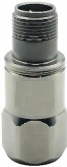
此系列产品是一款工业振动测量用IEPE加速度传感器，其特点是采用环形剪切模式的陶瓷晶体为敏感元件，具有长期保持输出稳定的特性。此加速度传感器的内部电路是在IEPE的两线制系统上同时提供恒流源激励和传输低阻抗电压输出信号，信号地内部屏蔽，并与外壳隔离；同时信号放大电路设计考虑了极性反向保护。外壳采用激光焊接工艺以保证产品的密封性；输出连接头采用标准的MIL-C-5015玻璃绝缘连接器以满足不同环境下使用时输出的稳定性；同时此系列加速度传感器支持粘合剂安装，也支持1/4-28的螺纹孔牢固安装。此系列加速度传感器具有频带响应宽和抗冲击的特性，所以对于环境比较恶劣的工业振动监控和测量使用来说，此系列绝对是一款理想的加速度传感器。另外，我司还提供与标准MIL-C-5015接头配套的线缆：型号16A-L可选，具体参见配件表格。
